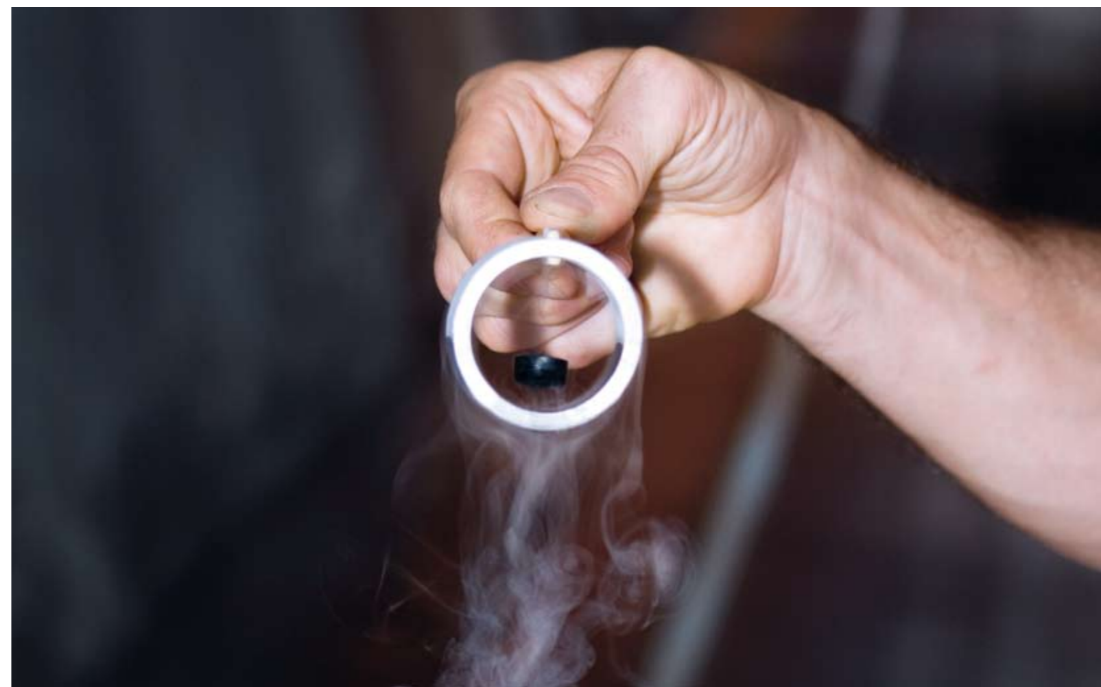
Lévitiation d'un supraconducteur à haute température critique dans un champ magnétique. (PhysiScope, UNIGE)
